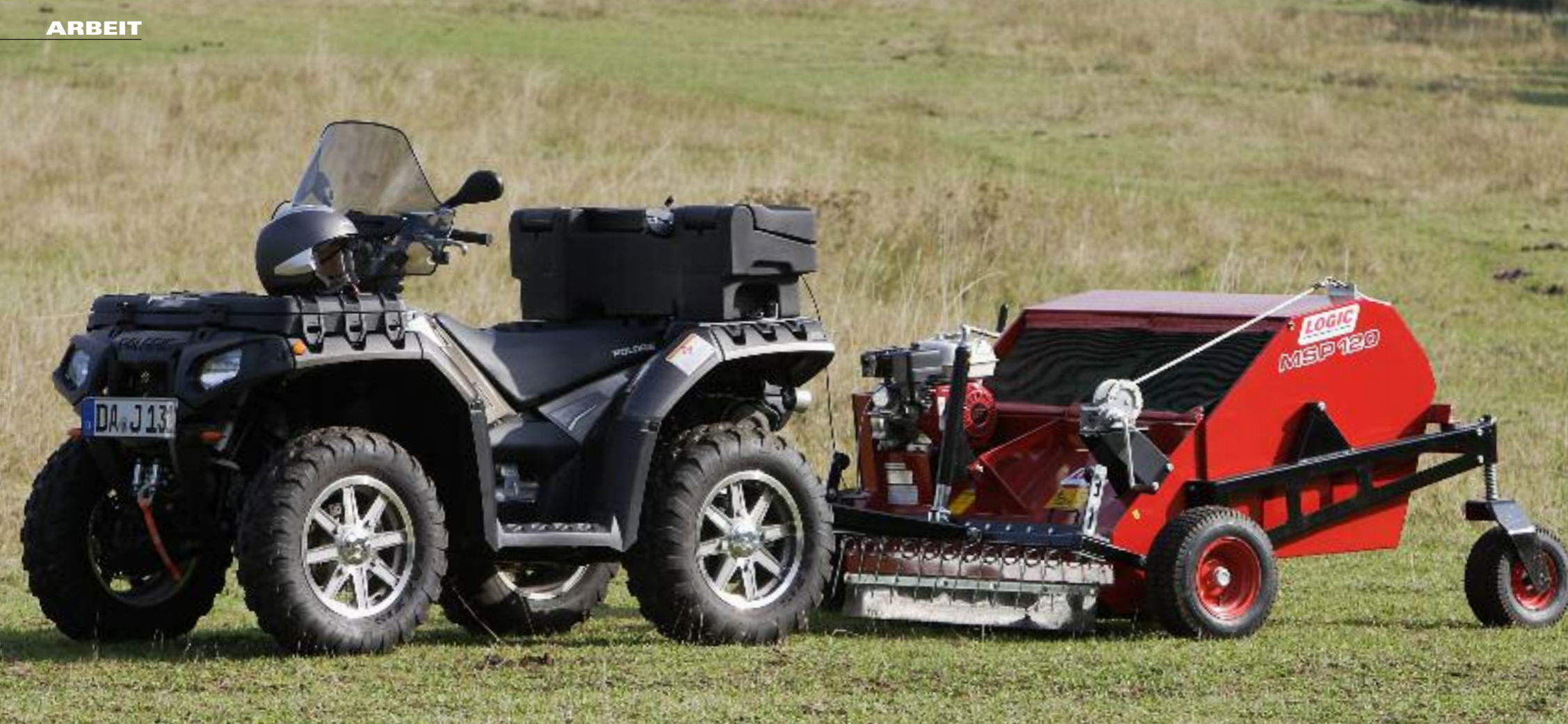
Der Honda-Motor leistet 5,5 PS und treibt eine rotierende Bürste an
