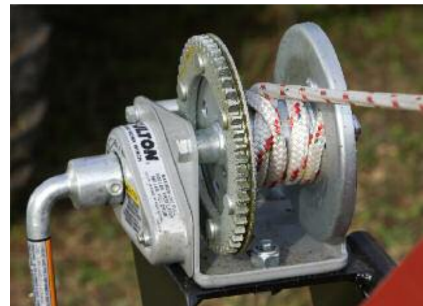
Leichtgängige Winde, mit der sich der Sammelbehälter kippen lässt
