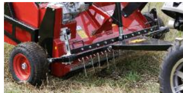
Mit der Zackenschiene löst man hartnäckig haftende Kothaufen
