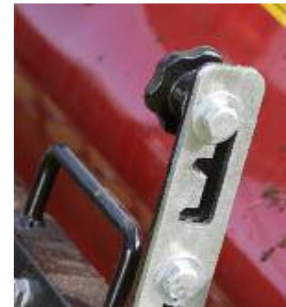
Der optionale Zackenrechen ist in der Höhe in drei verschiedenen Stufen einstellbar
