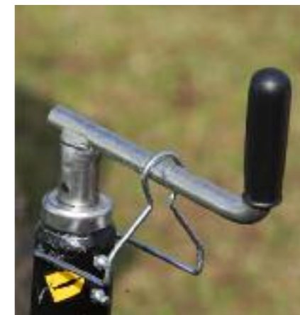
Mit der Arretierung lässt sich die Höhe der Bürste fixieren. Alle Schmiernippel, wie hier an der Kurbel, sind leicht erreichbar
