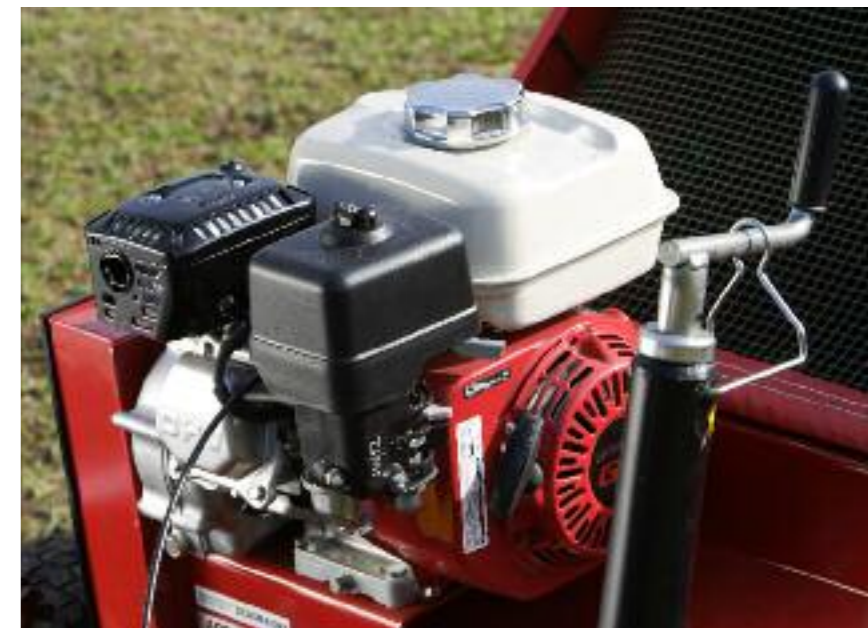
Der Honda-Motor leistet 5,5 PS und treibt eine rotierende Bürste an
